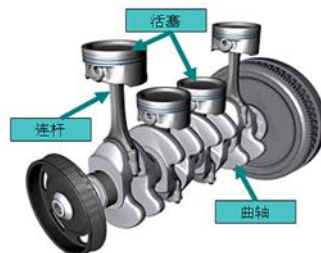
曲轴在内燃机内部的结构图
